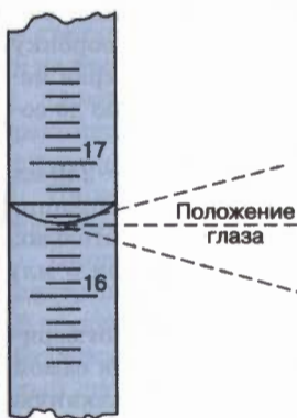
Рис. 89. Отсчеты по шкале бюретки при разном положении глаза
